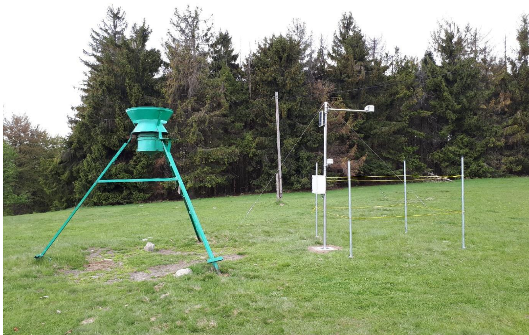
Obr. 21 Nově instalovaná automatická sněhoměrná stanice a totalizátor (zvláštní typ srážkoměru) na Velké Čantoryji v Beskydech.
